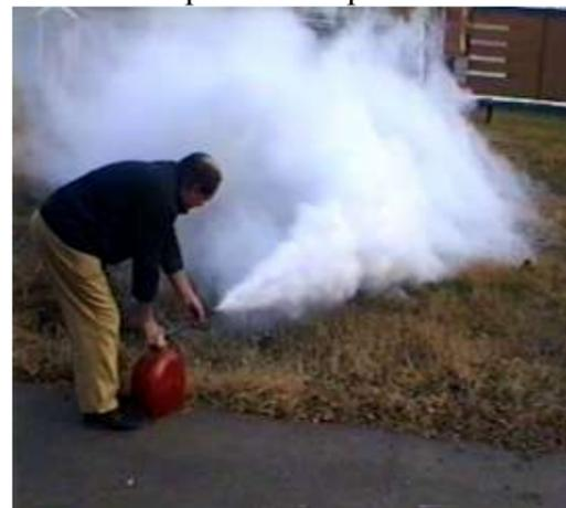
**Углекислотные огнетушители (ОУ)** предназначены для тушения загорания различных веществ и материалов, а также электроустановок, кабелей и проводов, находящихся под напряжением до 10 кВ (10000 В).
