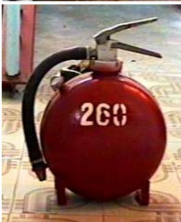
закрытие выпускного клапана при тушении пожара. При наличии горящего пролива около технологического оборудования тушение начинать с пролива с последующим переходом непосредственно на оборудование. Принцип работы переносного огнетушителя ОП-10(З) аналогичен ОП-50(З). После окончания тушения давление в огнетушителе должно быть снижено за счет открытия выпускного клапана.
